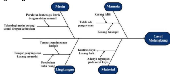
Gambar 9. Diagram Sebab Akibat Cacat Papan Kayu Melengkung (Sumber: Data diolah oleh penulis, 2025)
