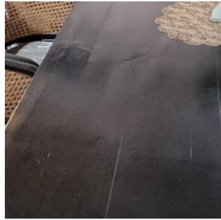
Gambar 3. Contoh Cacat Pelapis Meja Kayu Menggelembung (Sumber: Dokumen Pribadi, 2025)
