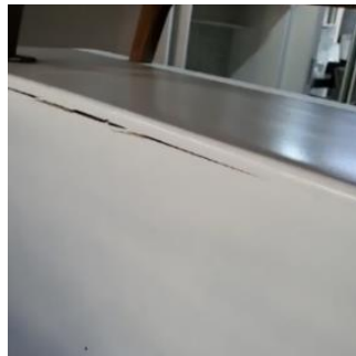
Gambar 1. Contoh Cacat Permukaan Meja Kayu Retak (Sumber: Dokumen Pribadi, 2025)
